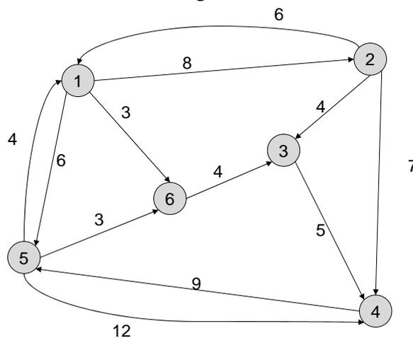
**Solución.** Del nodo 2 al nodo 1: (2,1); del nodo 2 al nodo 3: (2,3); del nodo 2 al nodo 4: (2,4); del nodo 2 al nodo 5: (2,1,5); del nodo 2 al nodo 6: (2,1,6).
