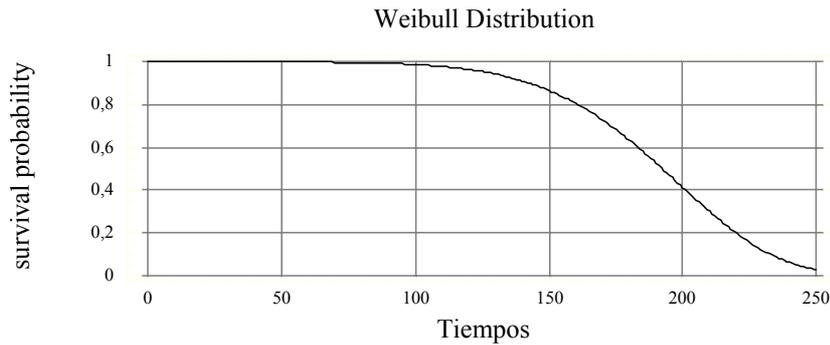
**Figura 19: función de supervivencia de los componentes del Ejemplo 3. La probabilidad de que falle antes de 100 horas es muy baja.**
