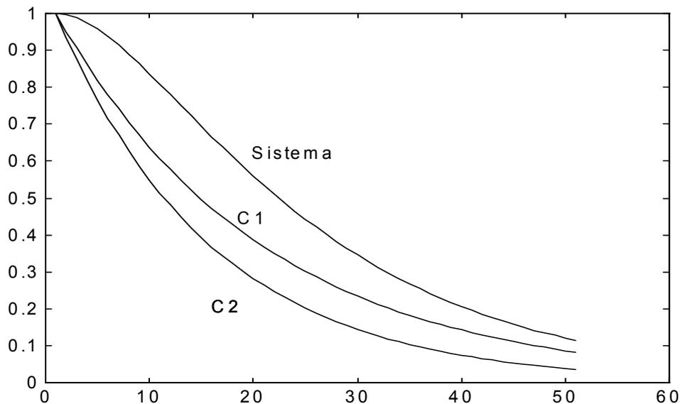
**Figura 31: Fiabilidad de las componentes y sistema paralelo**
