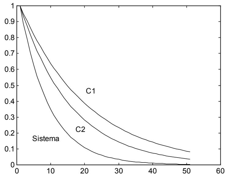
**Figura 29: Supervivencia de los componentes (C1 y C2) y del**
