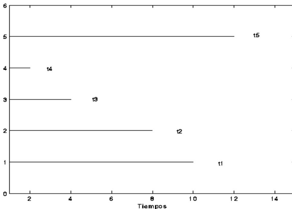
**Figura 1: Duraciones de un proceso. Los componentes puestos a prueba han durado unos tiempos  $t_1, t_2, \dots, t_5$ .**
